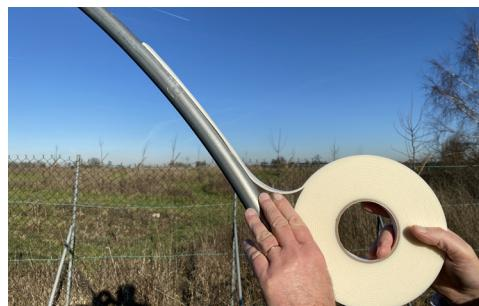
Le ruban mousse polyéthylène cellulaire résiste à l'humidité. Il éloigne la bâche de l'acier et évite ainsi son contact direct avec le métal trop chaud ou trop froid. Il est fourni en rouleaux de 10 m de long, 20 mm de large, 3 mm d'épaisseur. Il possède une face adhésive et une face auto - glissante afin de faciliter la pose de la bâche. Il atténue les effets des fortes variations de température et prolonge la vie de la bâche.
